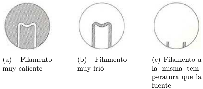
Figura 2.6: Aspecto del filamento de la lámpara en el ocular del pirómetro óptico
