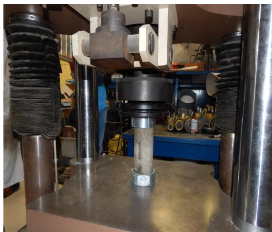
FIGURA 5.4 Ensaye de cilindro a compresión.
