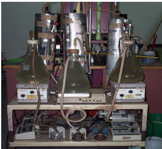
Fig. 10. RALLFA utilizados en la experimentación (Rincón-Acelas, 2006)
