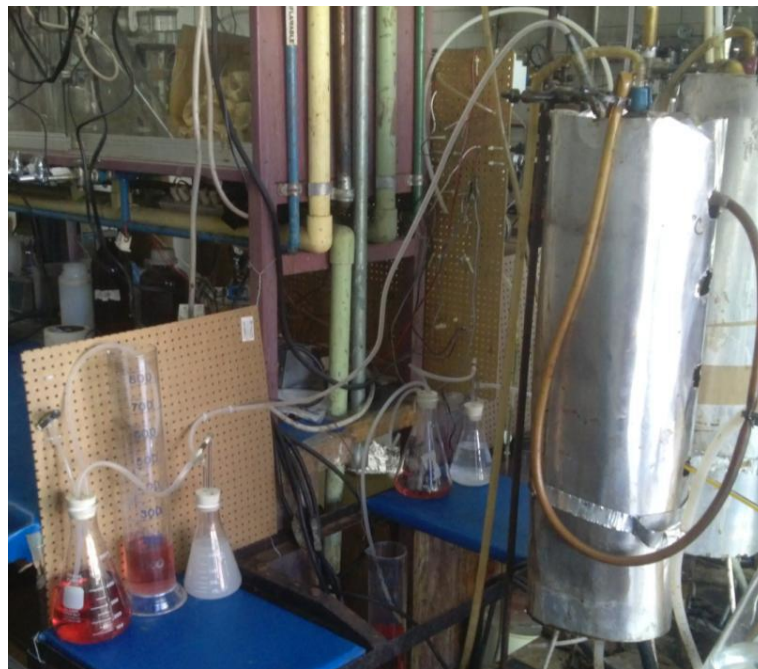
Fig. 21. Fotografía de RALLFA a 45°C con trampa de CO 2 , filtro de H 2 S y medidor de biogás por desplazamiento de agua
