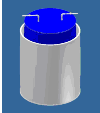
Fig. 8. Gasómetro-filtro (Autodesk Inventor@2010)
