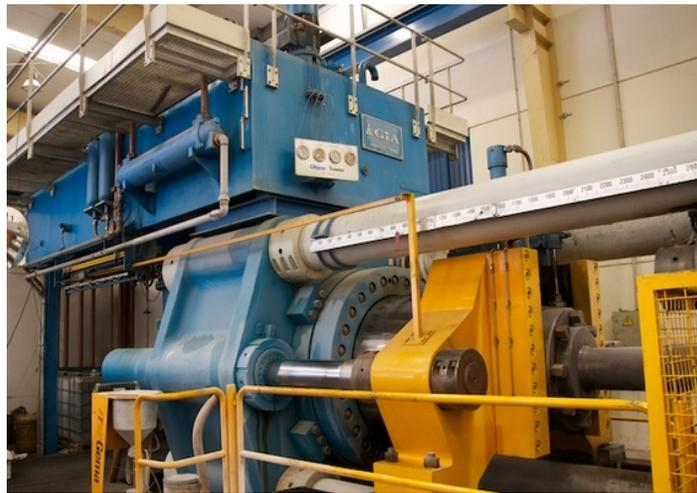
Figura 1.8 Prensa de 4 000 toneladas para extrusión de aluminio. [12]
