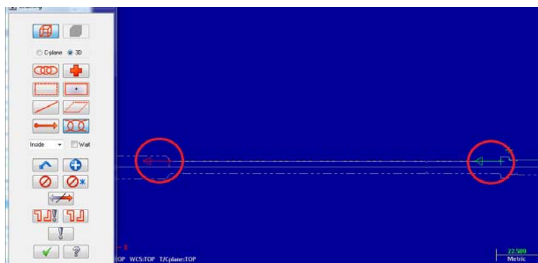
Figura 3.162 Corte del lado contrario con herramienta izquierda.
