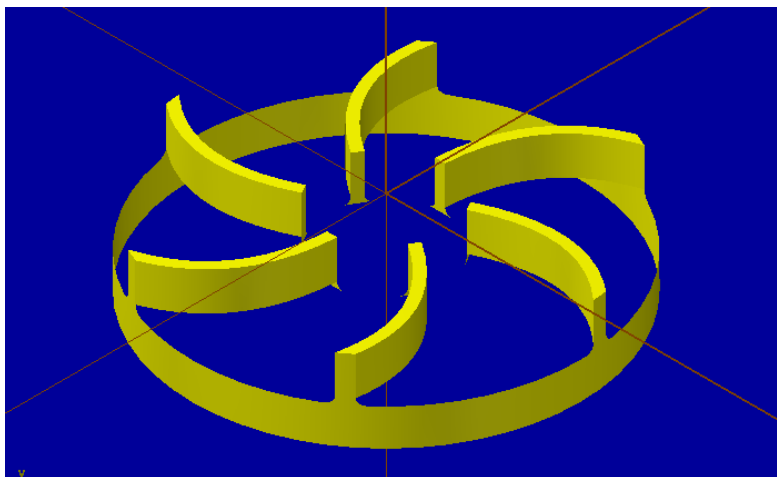
Figura 3.149 Superficies seleccionadas para el corte de los alabes.
