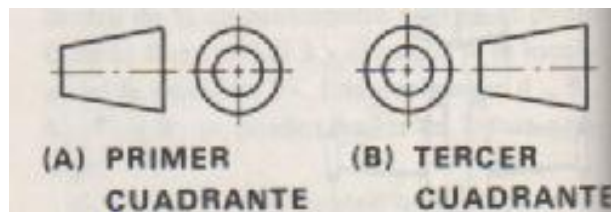
Figura 3.74 Representación de primer cuadrante (a) y tercer cuadrante (b) en un plano mecánico.
