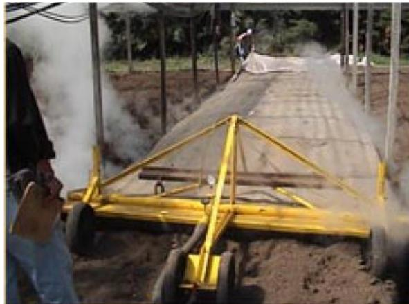
**Figura 1.** Equipo móvil de aplicación de vapor (Móvil Vap, 2004)
