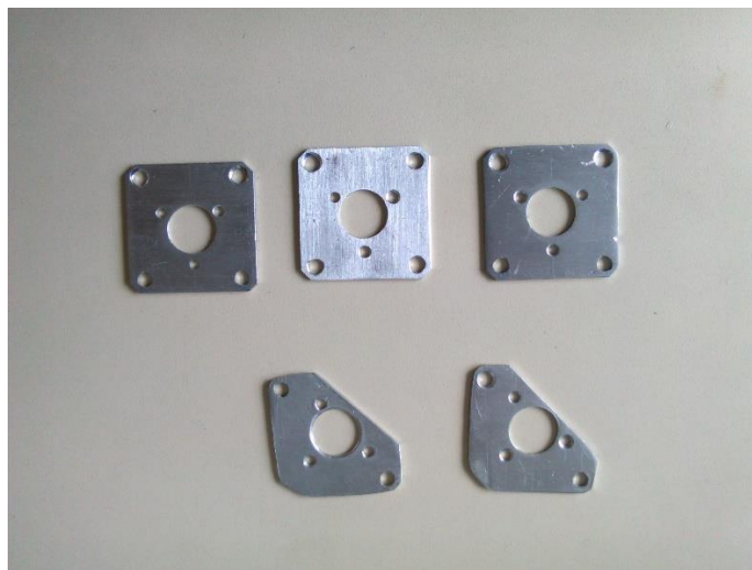
Figura 6.230 Soportes de aluminio para los motores EC-20.
