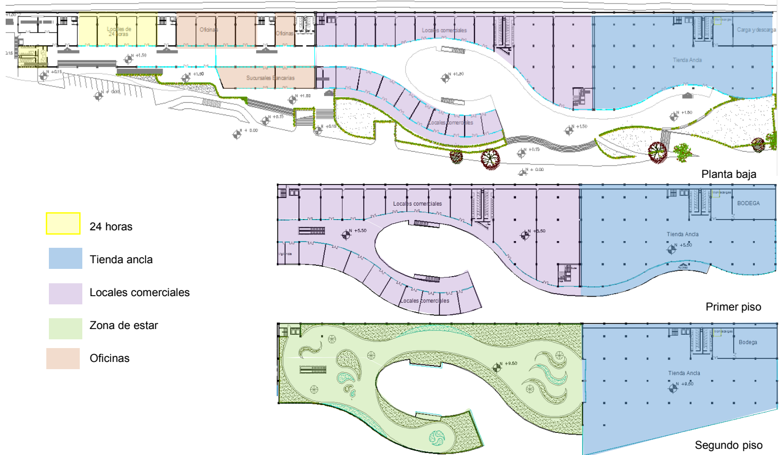
(19) Zonificación de la zona comercial en planta baja, primer y segundo piso.
