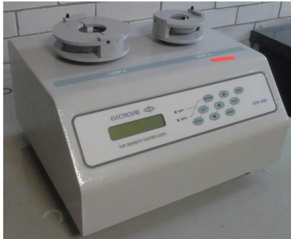
Figura 6. Densitómetro “ELECTROLAB”
