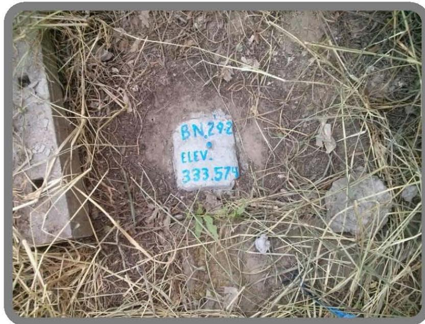
**Figura 89: BN 29-2 CAD.27+960.47 A 19.23 m LADO DERECHO SOBRE MOJONERA CON ELEVACIÓN PROMEDIO =333.574**
