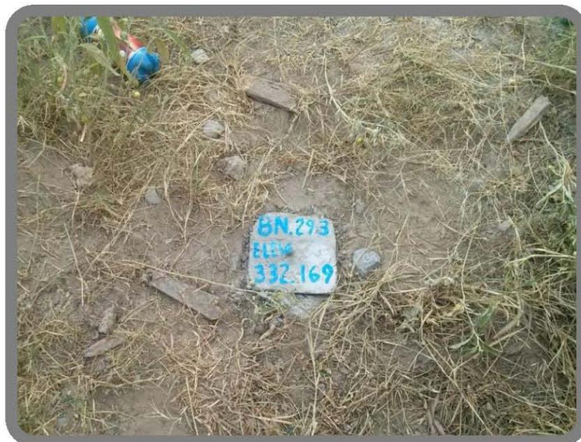
**Figura 90: BN 29-3 CAD.28+168.14 A 18.71m LADO DERECHO SOBRE MOJONERA CON ELEVACIÓN PROMEDIO=332.169**
