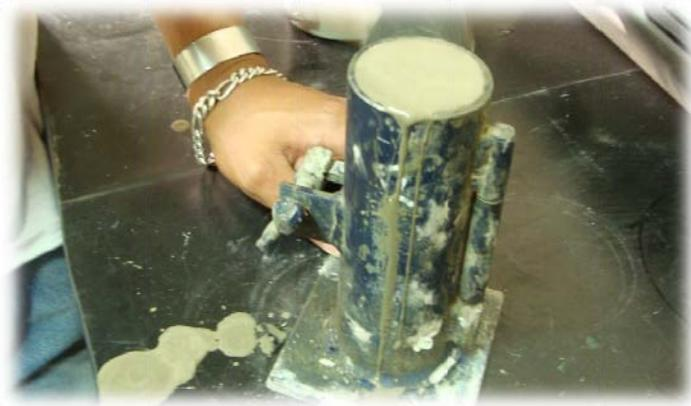
*Figura 5.19.- Cilíndricos para la elaboración de las probetas de ensaye en laboratorio.*
