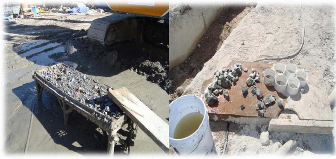
*Figura 5.24.- Obtención de muestras de la roca basal*
