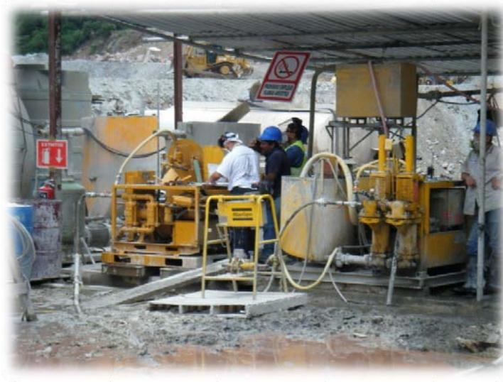
*Figura 5.30.- Equipo de mezclado para la elaboración de las mezclas de inyectado y autofraguante.*
