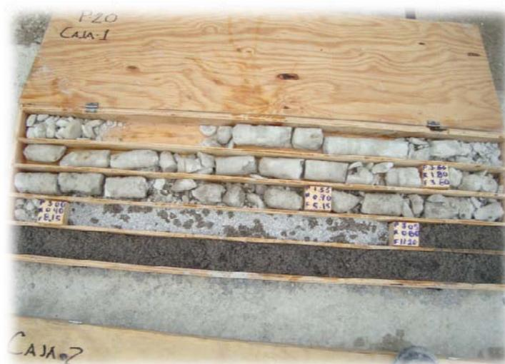
Figura 5.23.- Recuperación de núcleo – Barreno Panel 20 pantalla aguas abajo P.H. La Yesca
