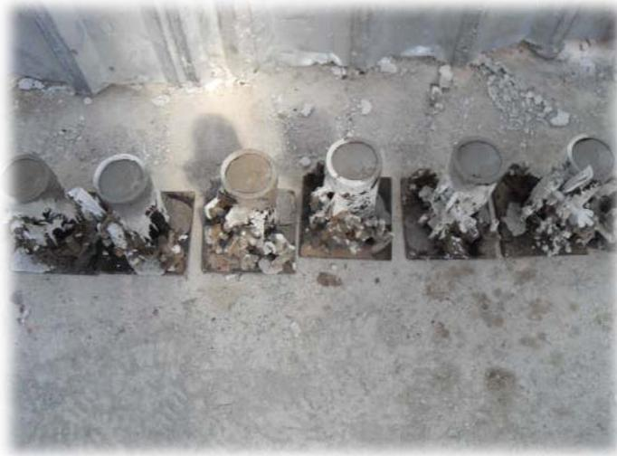
*Figura 5.18.- Moldes cilíndricos para la elaboración de las probetas de ensaye.*
