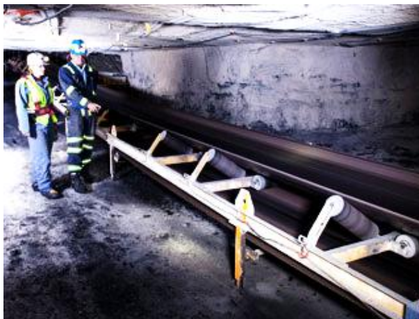
Figura 1.10 Sistema de banda transportadora en supervisión
