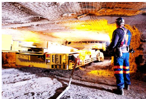
Figura 1.5 Minero continuo en operación
