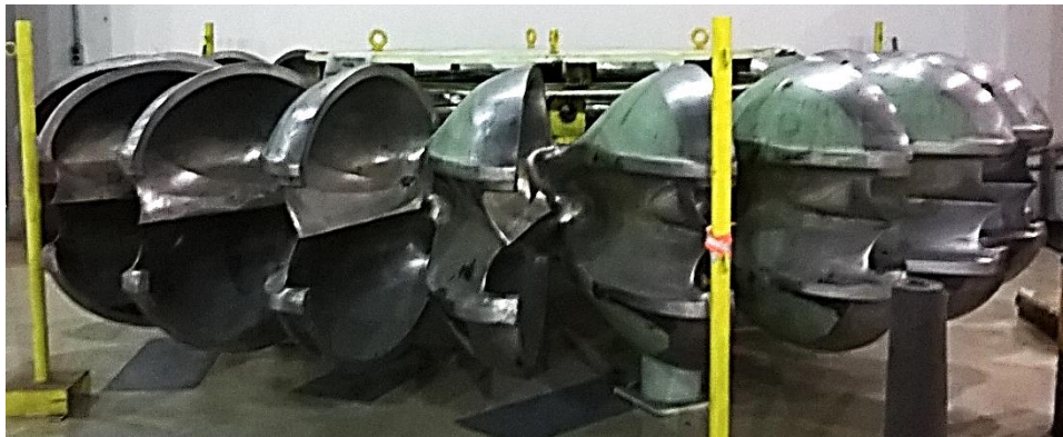
Figura 2.3.4 Turbina Pelton en la casa de máquinas en la C. H. Zimapán.
