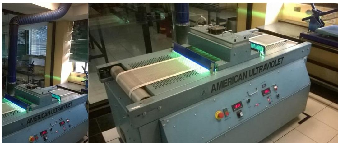
*Figura 2.6. Equipo empleado en el proceso de curado.*
