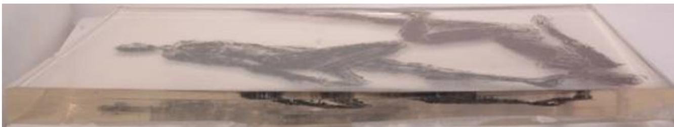
La siguiente pieza hecha con encausto derivó en una reacción exotérmica adversa en el segundo vaciado de resina por el exceso de catalizador con lo que fue inminente el quiebre de la misma:
