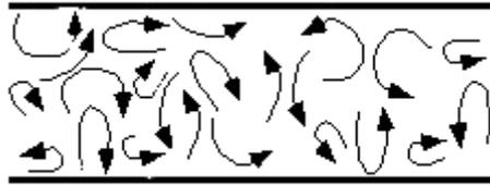
Cuando la velocidad de flujo de un fluido resulta suficientemente grande, se rompe el flujo laminar y se establece la turbulencia. La velocidad crítica por encima de la cual el flujo a través de un tubo resulta turbulento, depende de la densidad y de la viscosidad del fluido y del radio del tubo.
