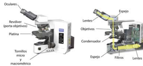
Figura 2.1: -Componentes ópticos y mecánicos- Estos elementos señalados son comunes a todos los microscopios ópticos, ya sean modernos como el que se muestra en la imagen o uno de los primeros desarrollos de microscopios ópticos compuestos. modificada de (13)
