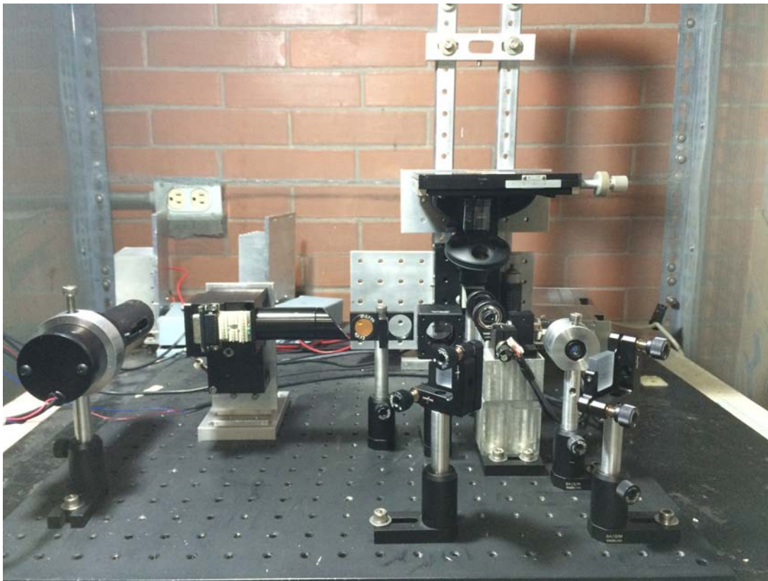
Figura 3.9: -Montaje del Prototipo- Fotografía del microscopio confocal en la fase final del montaje, ésta es la configuración actual del microscopio.
