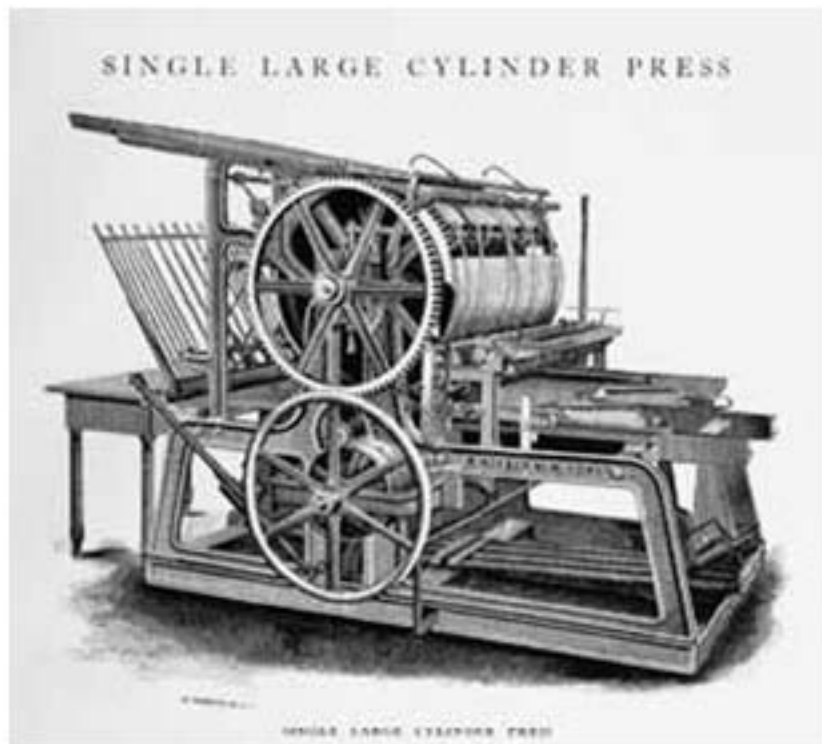
Fig. 5 Single Large Cylinder Press , prensa para piedra con alimentación automática de papel.
