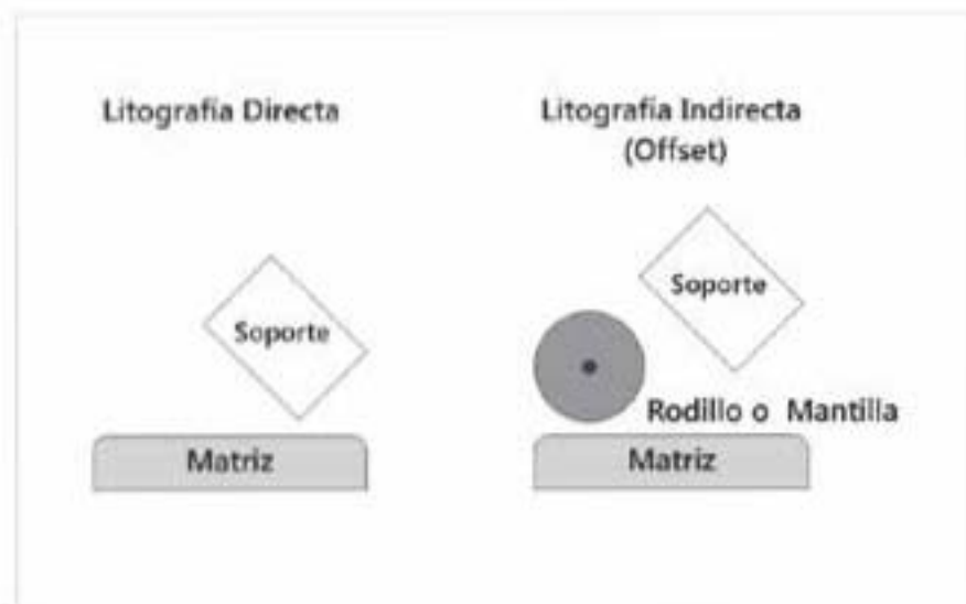
Fig. 9 Esquema simplificado de la transferencia de tinta en la Litografía.
