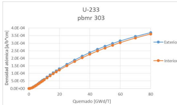
Figura 28. Gráficas comparativas de la evolución del U^{233} en las zonas exterior e interior para los modelos "pbmr 30", "pbmr 298" y "pbmr 303".
