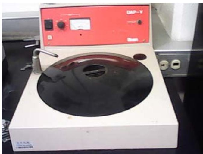
Figura 26. Pulidora semiautomática Struers modelo DAP-V.
