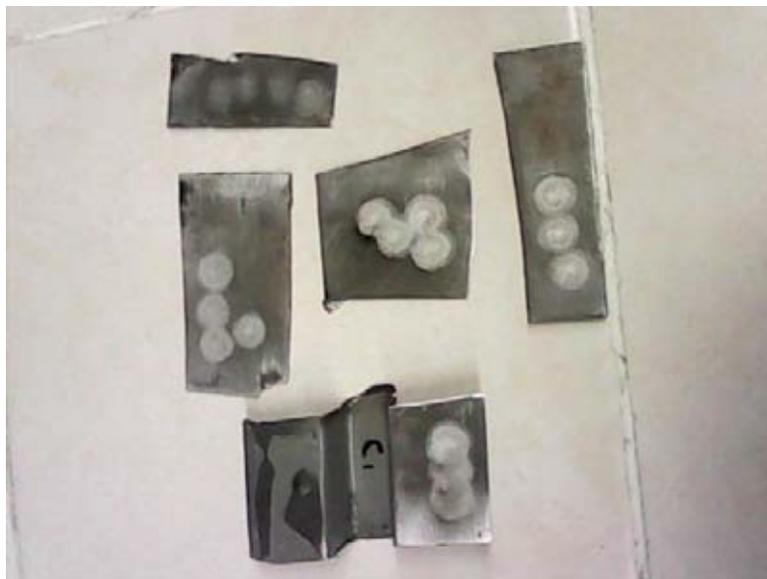
Figura 21. Probetas utilizadas para la prueba de chispa.
