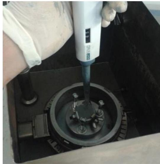
Figura 35. Deposición del sol gel por spin-coating
