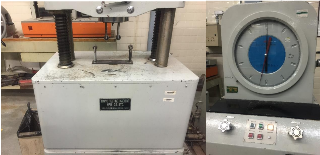
Figura 5: Prensa Hidráulica utilizada para el análisis mecánico del material óseo. Laboratorio de ingeniería mecánica, Instituto Tecnológico de Hermosillo.
