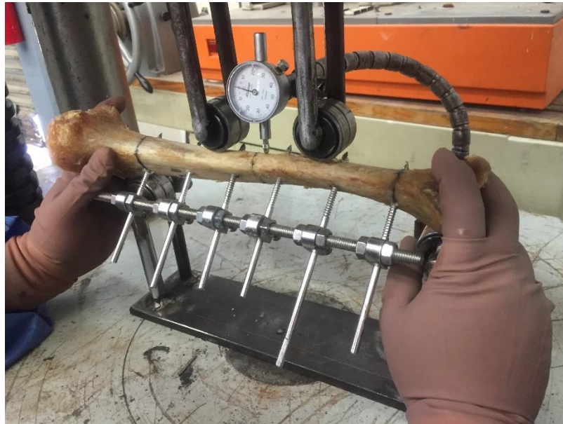
Figura 9. Aplicación de prueba biomecánica utilizando dispositivo de cuatro puntos (Quintanar 2015).
