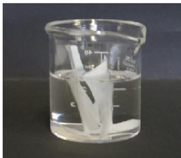
**Figura 3.1:** Limpieza de láminas de PTFE.
