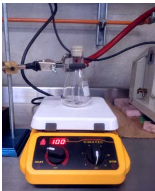
Figura 2.7: Películas en deshumificación. Se colocan películas del mismo reactante en un matríz en vacío dinámico por dos horas a temperatura de 120 °C.
