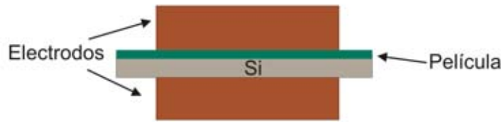
Figura 2.9: Dispositivo experimental empleado para medir la conductividad transversal de las películas y sustrato de Si.
