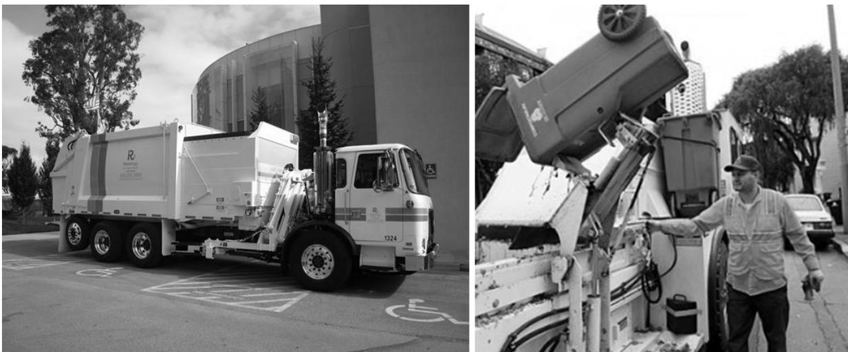
Ilustración 21: Camiones de recolección de RSU. A la izquierda se observa unidad completa y a la derecha se observa la operación del servicio. Fuente: Página de internet de la empresa Recology, Mayo 2015.
