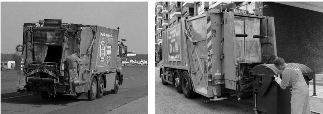
Ilustración 9: Camión recolector de residuos de la compañía BSR Berlín equipado con sistema mecánico de volteo y compresión de residuos. Fuente: Sitio web de la compañía BSR consultado en Enero de 2014
