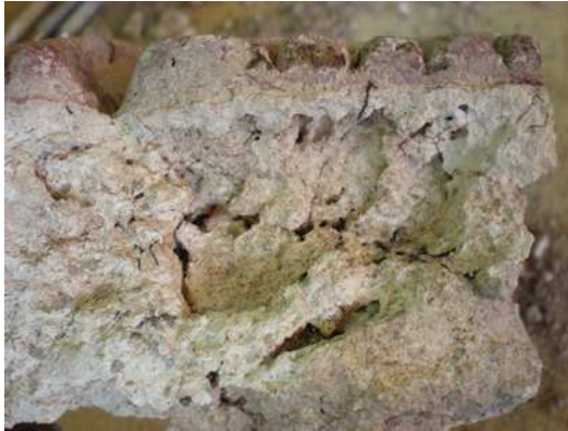
Ilustración 17: Sección transversal, pueden verse diversas capas de estuco que forman la figura. Fotografía: Luisa Straulino.
