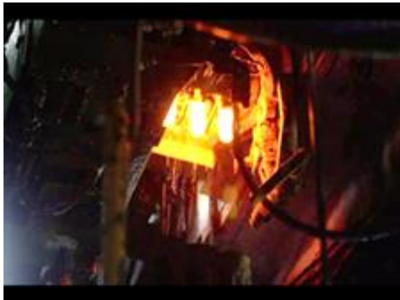
Figura 6. Dosificador. Caída de 3velas para pasar a la etapa de formado.
