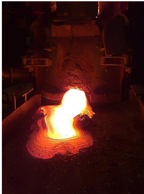
Figura 11. Drenado de Horno intermitente sobre agua donde se solidifica y una vez listo el horno se reutilizara este vidrio o cullet para su producción.
