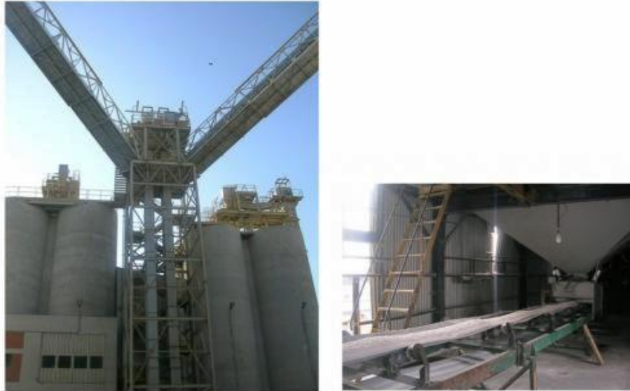
Figura 3. Silo de almacenamiento y transporte de materia prima. De esta forma la alimentación de estas materias al inicio de la línea de producción puede realizarse de forma continua y exacta.
