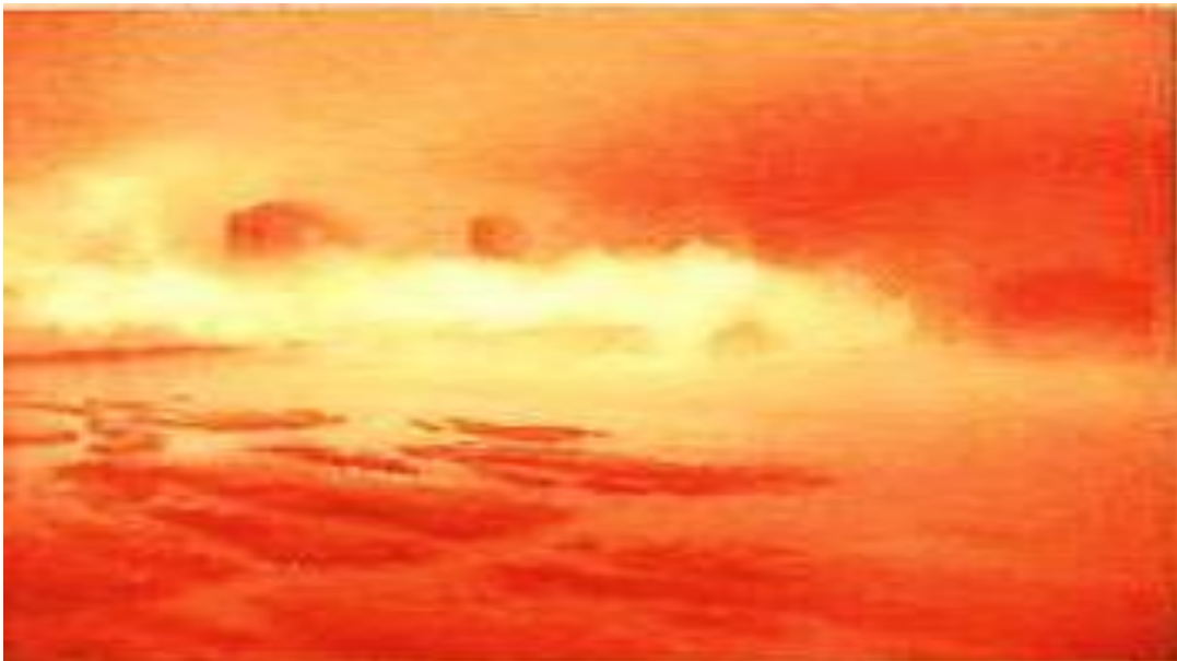
Posteriormente, pasa al alimentador (forehearths) donde se acondiciona el vidrio (Figura 5). Figura 4. Fundición de vidrio. Interior de Horno (1535° C 5). Esta sección es de suma importancia para la formación de carga ya que aquí se aproximadamente) con materia prima observable en proceso de fundición.
