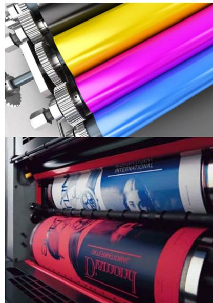
*La impresión offset se realiza mediante planchas monocromáticas, de modo que debe crearse una plancha por cada color a imprimir; con el modelo CMYK*
