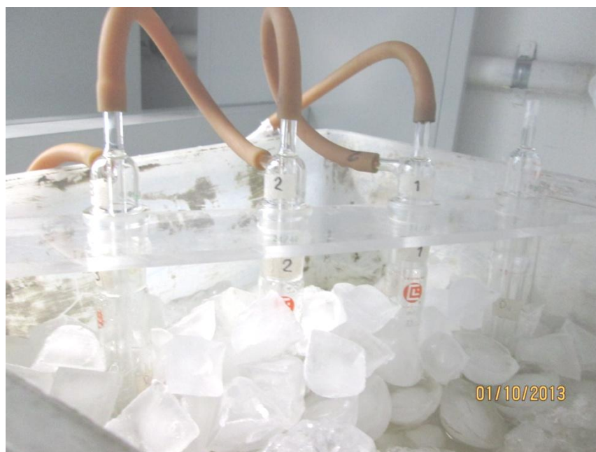
Figura 3.3 Burbujeadores conectados en serie en cuba con hielo.
