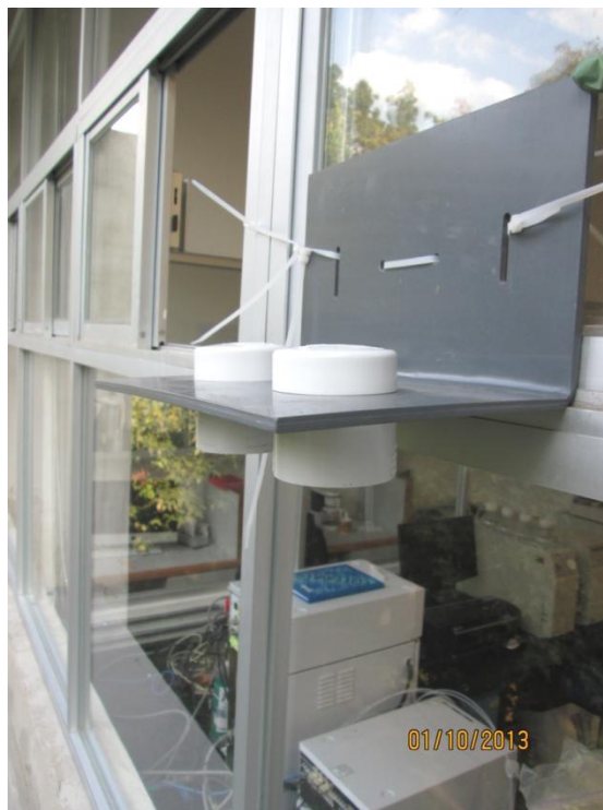
Figura 3.7 Captadores pasivos colocados en la ventana.
