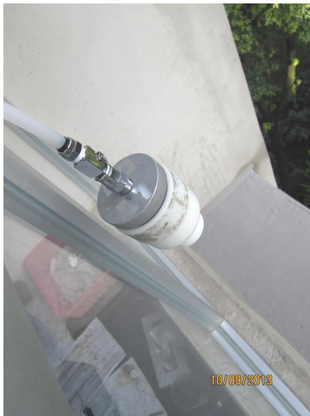
Figura 3.4 Prefiltro colgando de la ventana.
