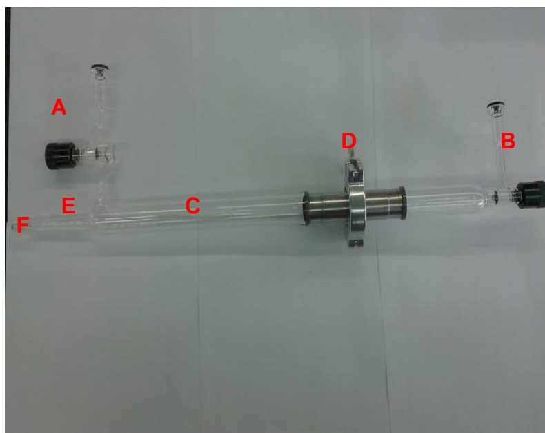
Figura 2.2 Celda de DRS para sólidos UV-Vis-NIR in situ .
