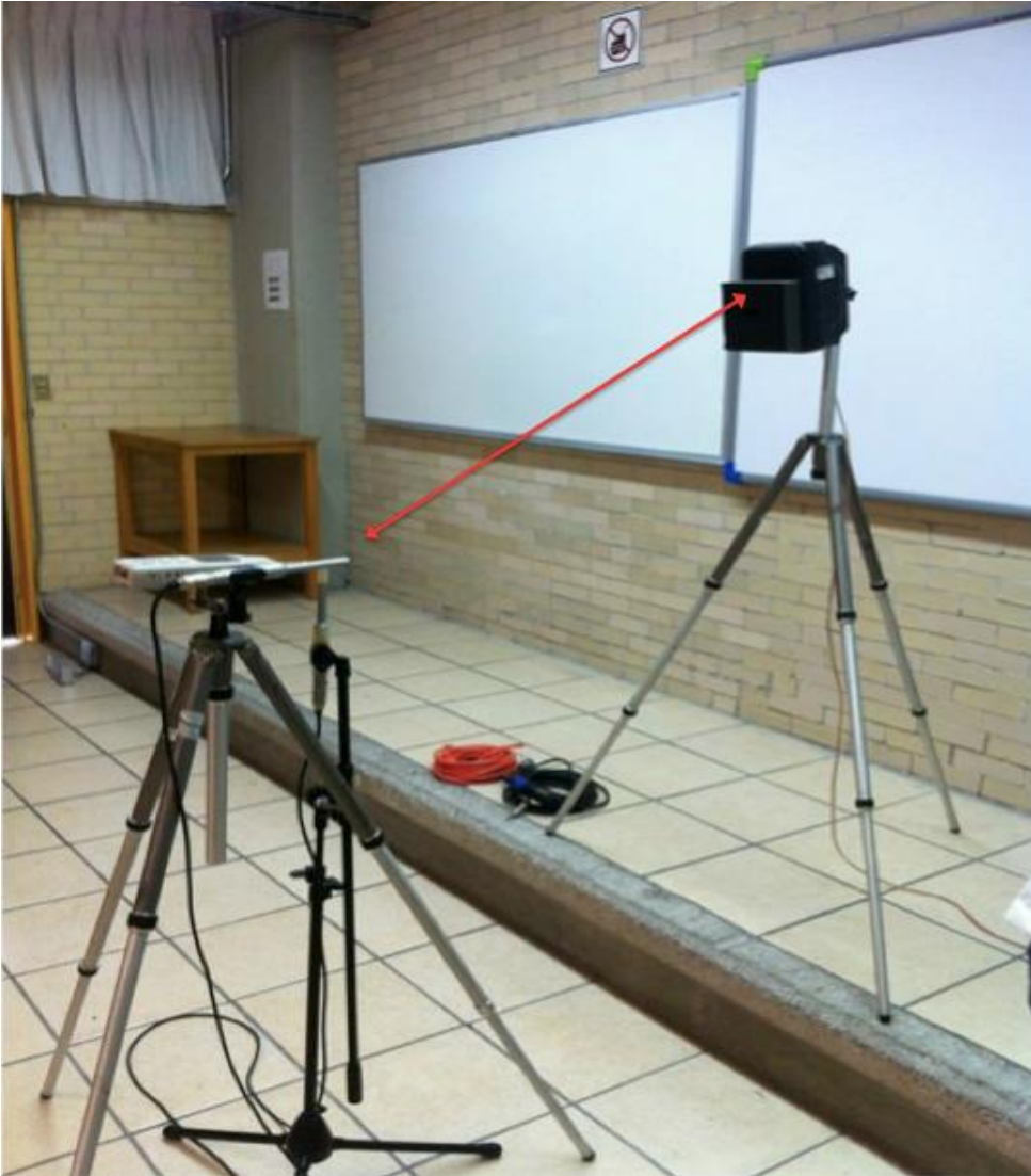
Figura 2.28 Posición del micrófono omnidireccional en frente del simulador de boca, a 1 m de distancia para realizar el aplanamiento de la señal MLS
