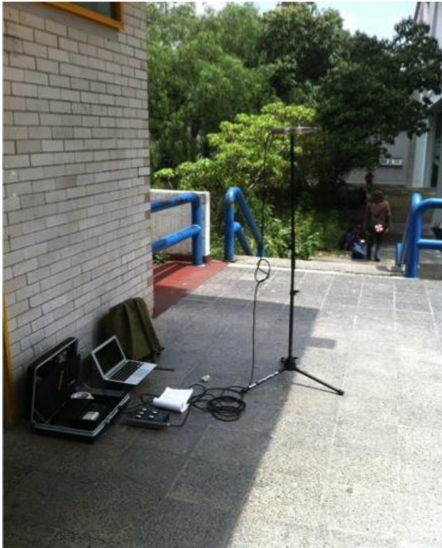
Figura 2.39 Posición del sonómetro y micrófono a 1.50 m de altura y por lo menos 1m de separación de cualquier superficie reflejante
