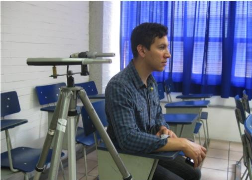
Figura 3.12 El micrófono omnidireccional se coloca a la altura del oído de una persona que se encuentra sentada dentro del salón de clases
