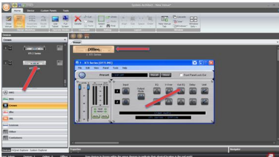
Figura 2.25 Primeros ajustes para la equalización de la señal MLS en System Architect 3.4
