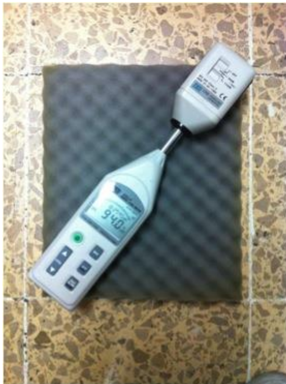
Figura 2.38 Calibración del sonómetro a 94 dB – 1kHz
