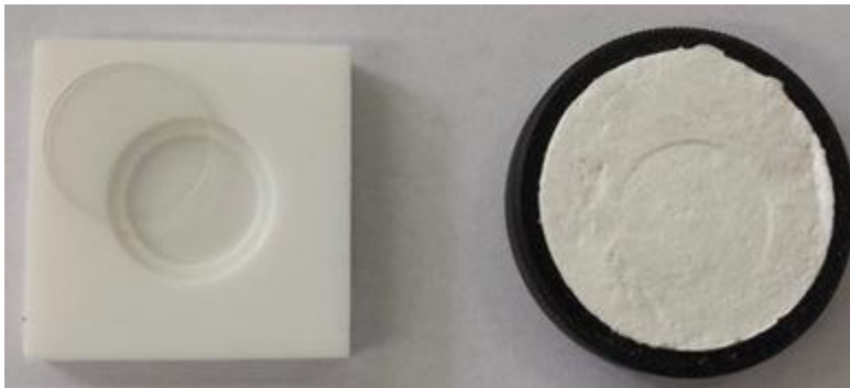
Figura 10. Ventana de cuarzo con porta muestras y polotetrafluoroetileno.
