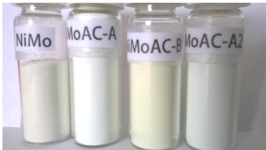
Figura 8. Catalizadores preparados de Mo/ Al 2 O 3 promovidos con Ni y AC como agente quelante. NiMo/Al 2 O 3 , NiMoAC-A/Al 2 O 3 , NiMoAC-B/Al 2 O 3 y NiMoAC-A2/Al 2 O 3 de derecha a izquierda.
