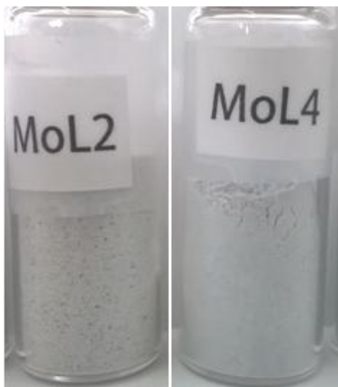
Figura 11. Catalizadores de \text{Mo}/\text{Al}_2\text{O}_3 con diferente tamaño de partícula. \text{Mo}/\text{Al}_2\text{O}_3 -L2 (MoL2 \phi < 0.104 mm) y \text{Mo}/\text{Al}_2\text{O}_3 -L4 (MoL4 0.147 mm < \phi < 0.104 mm).
