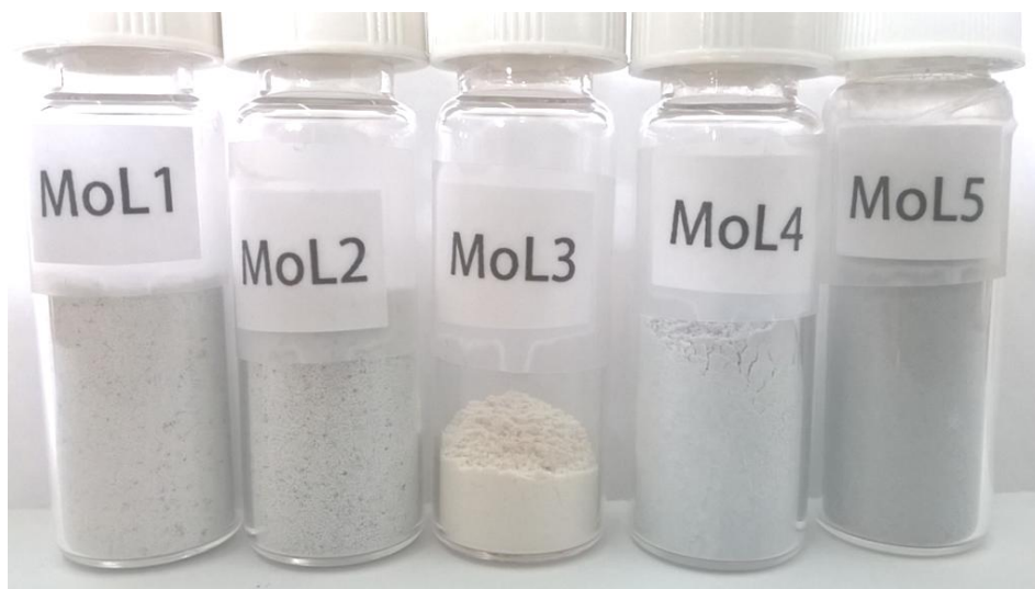
Figura 5. Catalizadores de Mo/Al 2 O 3 con variaciones en el método de preparación, calcinados a 300 °C. MoL1) Mo/Al 2 O 3 -L1, MoL2) Mo/Al 2 O 3 -L2, MoL3) Mo/Al 2 O 3 -L3, MoL4) Mo/Al 2 O 3 -L4 y MoL5) Mo/Al 2 O 3 -L5
