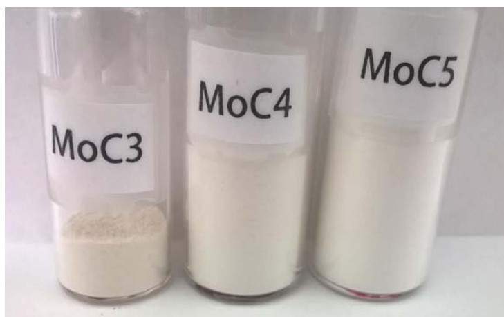
Figura 6. Catalizadores de Mo/Al 2 O 3 calcinados a diferentes temperaturas. MoC3) Mo/Al 2 O 3 -C3, MoC4) Mo/Al 2 O 3 -C4 y MoC5) Mo/Al 2 O 3 -C5
