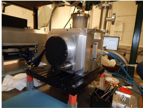
Figura 3.11: Cubo de aluminio que contiene a los CCD durante las pruebas eléctricas, dentro de el se reduce la temperatura y se genera el vacío requerido
