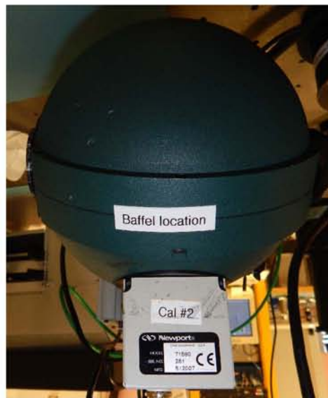
Figura 3.12: La esfera integradora proporciona iluminación uniforme sobre los CCD en prueba
