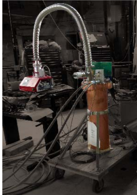
Figura 4.19: Bomba de vacío HiCUBE 80 Eco conectada al dewar. La fotografía fue tomada en el laboratorio SIDET del Fermilab durante una prueba del equipo
