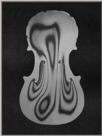
En un violín, las vibraciones de las cuerdas pasan a través del puente del cuerpo del instrumento. El cuerpo del instrumento tiene vibraciones propias –aquí visibles por efectos de interferencia– que entran en resonancia con las de las cuerdas. Normalmente se hace que la frecuencia de estas vibraciones corresponda con las de las cuerdas y dé el tono del violín.
