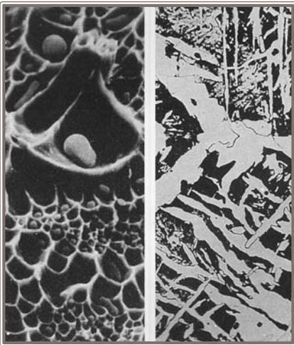
Fotografías de superficies metálicas obtenidas con un microscopio electrónico. A la izquierda, una pieza de ferrita (hierro) que se rompió por haber sido estirada excesivamente. Las partículas redondas son en realidad de sulfuro de manganeso y cada una de ellas tiene alrededor de una millonésima de metro de diámetro. A la derecha, una pieza de acero aumentada mil veces.
