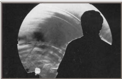
Fotografía especial que muestra una onda sonora creada por una chispa.
