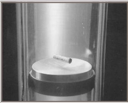
Una barra imantada introducida en estaño superconductor crea una imagen magnética en el plato y es por lo tanto repelida por la fuerza entre los polos iguales, de manera que permanece levantada por encima del plato. El campo del imán induce en el estaño corrientes persistentes que forman la imagen magnética.
