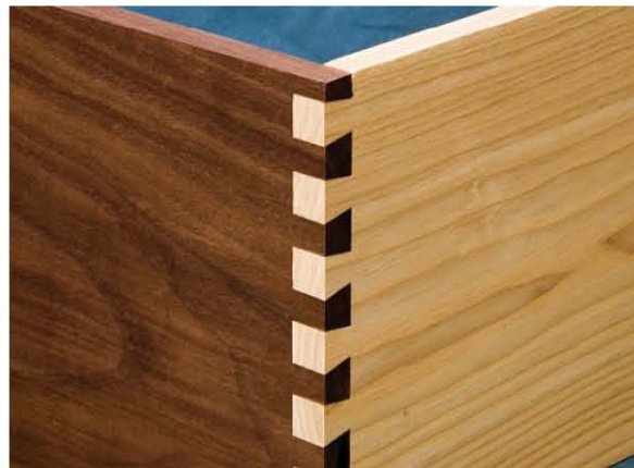
Fig 318. Los ensambles cola de milano serán fundamentales en el diseño.
