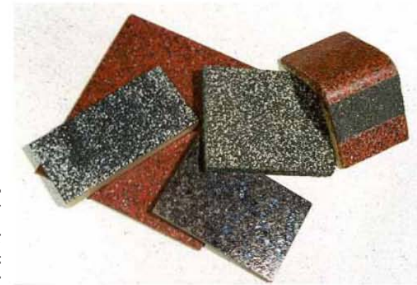
Fig 283. El Concreto Polimérico es más resistente que el Concreto Tradicional.
