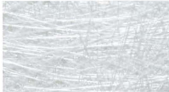
Fig 131. La fibra de vidrio puede reforzar mecánicamente un polímero.
