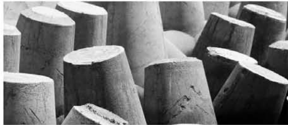
Fig 180. El Concreto es un ejemplo de Material Compuesto Particulado.
