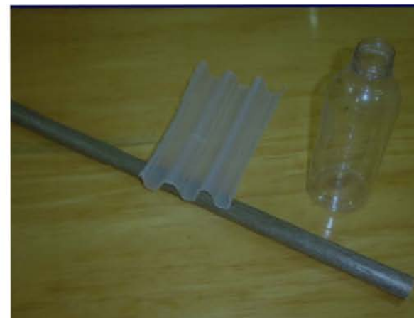
Fig 277. Productos obtenidos con una mezcla de PET reciclado y arcillas volcánicas.
