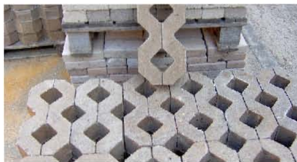
Fig 289. Celosías fabricadas con Concreto Polimérico.
