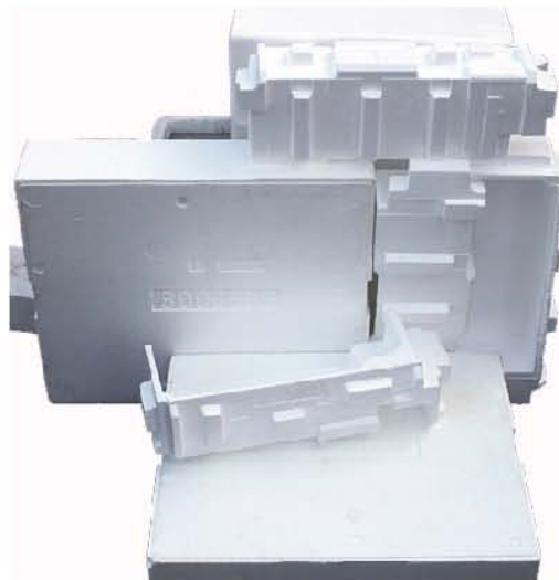
Fig 126. Cajas de PS Expandido.
