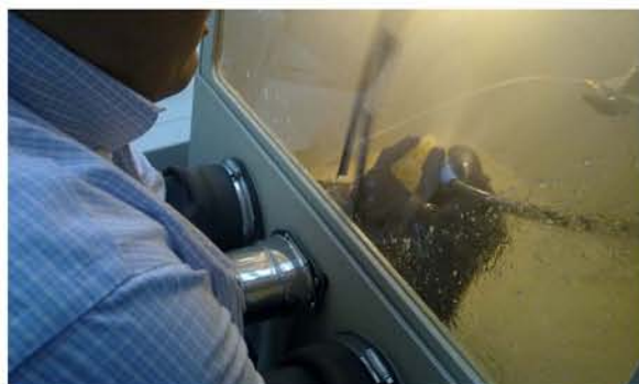
Fig 363. Con agua a presión se quita el material residual de la pieza.
