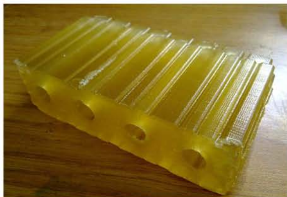
Fig 362. La pieza sale con bastante material residual que sirve de soporte.
