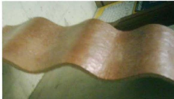
Fig 281. La lámina Flipard se fabrica con PE y fibras de agave.
