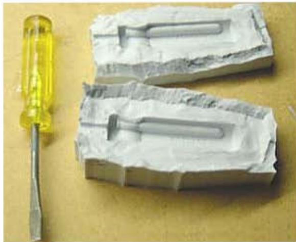
Fig 162. Empleo de la Fundición Hueca.
