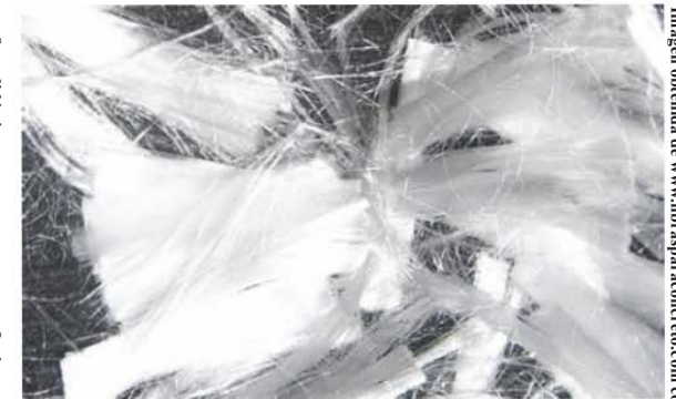
Fig 331. La correcta orientación de las fibras otorgará estabilidad dimensional.
