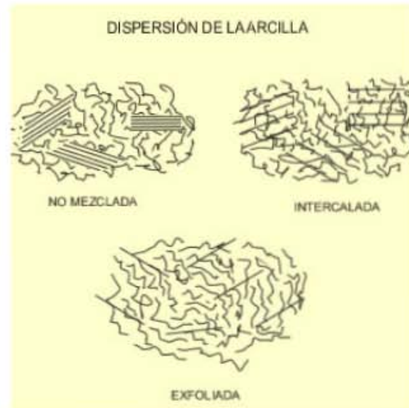
Fig 279. Dispersión de las arcillas en los nanocompuestos.
