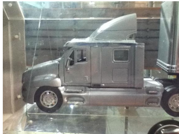
Fig. 5.16 Prueba de modelo tractocamión a 14 m/s
