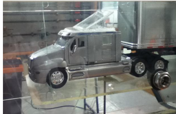
Fig. 5.12 Prueba de modelo tractocamión a 14 m/s, después de esta velocidad existe una vibración considerable que impide tomar lecturas de la fuerza aerodinámica.
