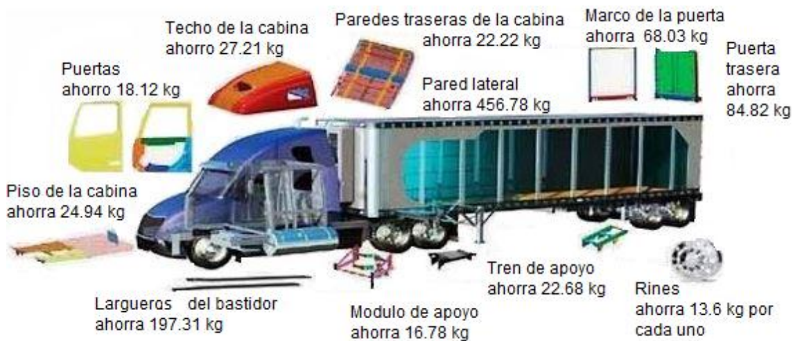
Fig. 1.13 Reducción del peso del vehículo por el uso de aluminio en algunas partes de la unidad [7]
