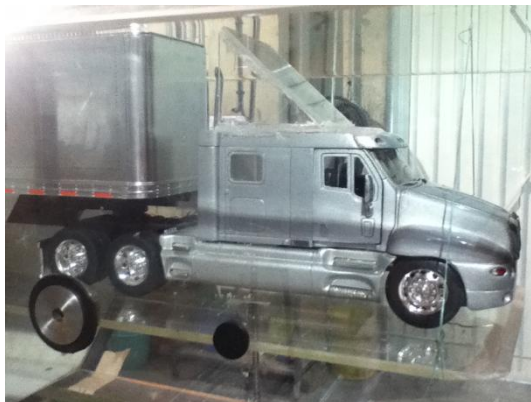
Fig.5.13 Modelo de tractocamión con deflector a 41°.
