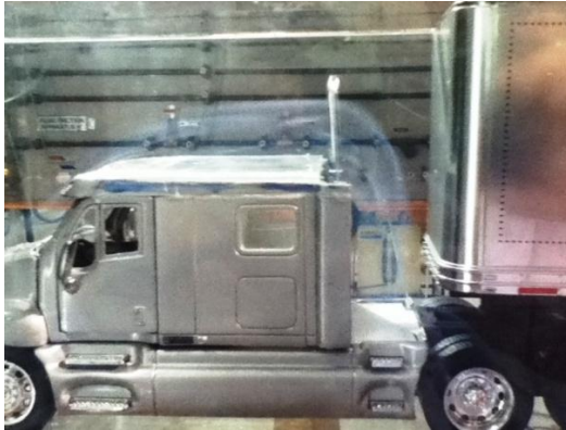
Fig. 5.22 Sin deflector de aire a una velocidad de 1 m/s
