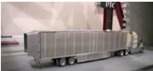
Fig. 5.30 Paneles de extensión
