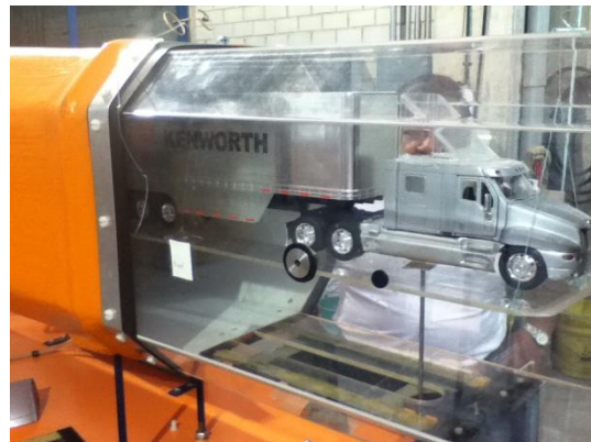
Fig. 5.14 Prueba de modelo tractocamión a 14 m/s
