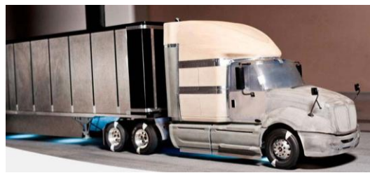
Fig. 5.31 Prueba con deflector de aire
