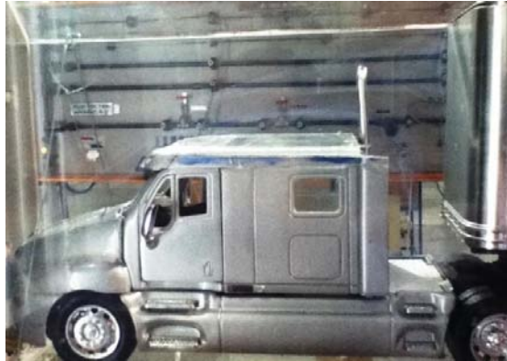
Fig. 5.23 Modelo tractocamión sin deflector a una velocidad de 4 m/s
