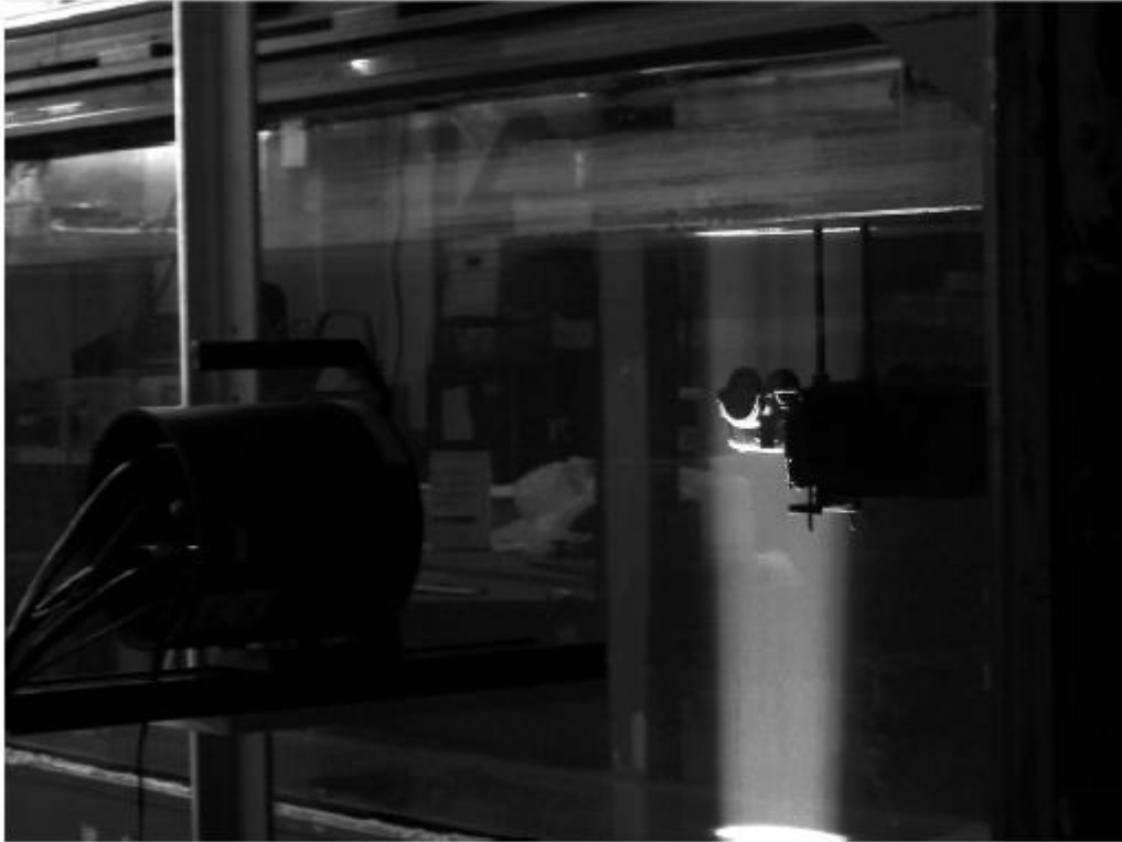
Fig. 5.17 Visualización de flujo de un modelo de tractocamión en un túnel de agua 22
