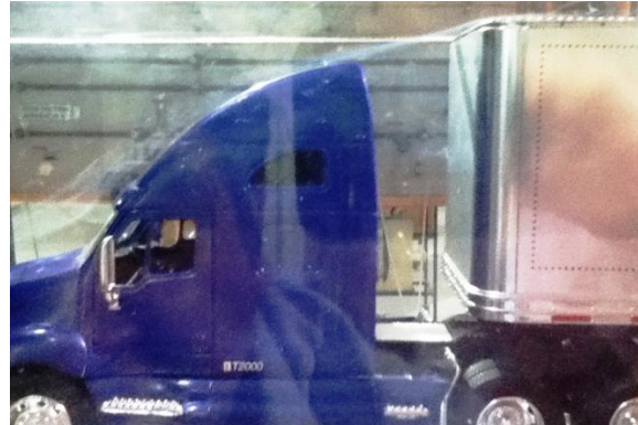
Fig. 5.19 Deflector de aire tipo concha completa una velocidad de 3 m/s
