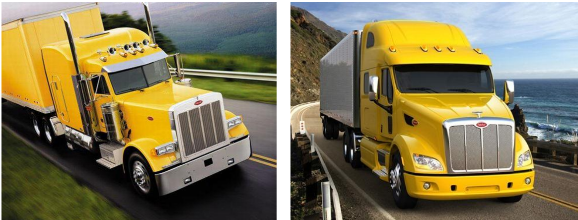
Fig. 1.6 Tractocamión Peterbilt tradicional modelo 389 (izquierda) y modelo 387 2 aerodinámico (derecha) [7].
