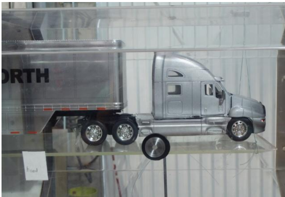
Fig. 5.7 Modelo de tractocamión y caja, pruebas preliminares
