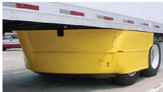
Fig. 1.10 Cubierta tipo bogie [7]
