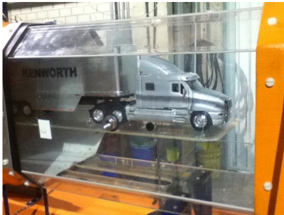
Fig. 5.15 Modelo de tractocamión con deflector de aire modificado tipo (media concha).
