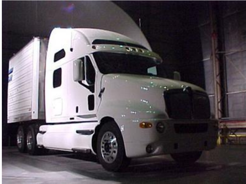
Fig. 3.2 Túnel de viento de tamaño real de Langley (LFST, por sus siglas en inglés) es lo suficientemente grande como para probar vehículos de tamaño real. Cortesía NASA Langley Research Center.
