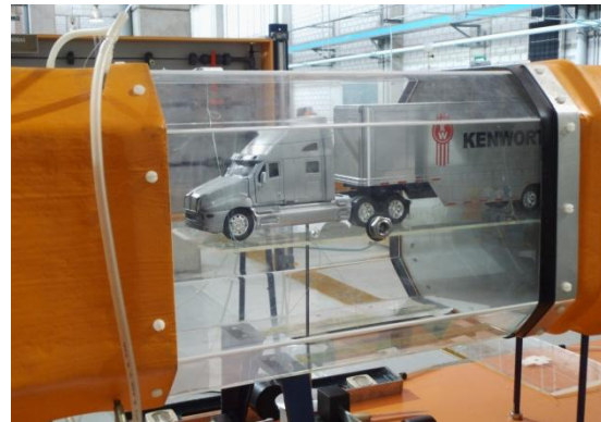
Fig. 5.8 Modelo de tractocamión y caja 14 m/s
