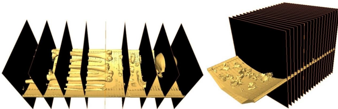
Figura 42. Formación de la superficie por medio de caras formadas por polígonos a partir de una rejilla 3D de un volumen render del material biológico a procesar
