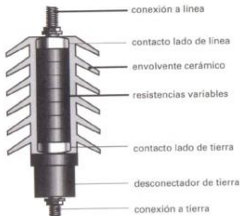
Fig. 7.2 – Apartarrayos de óxidos metálicos
