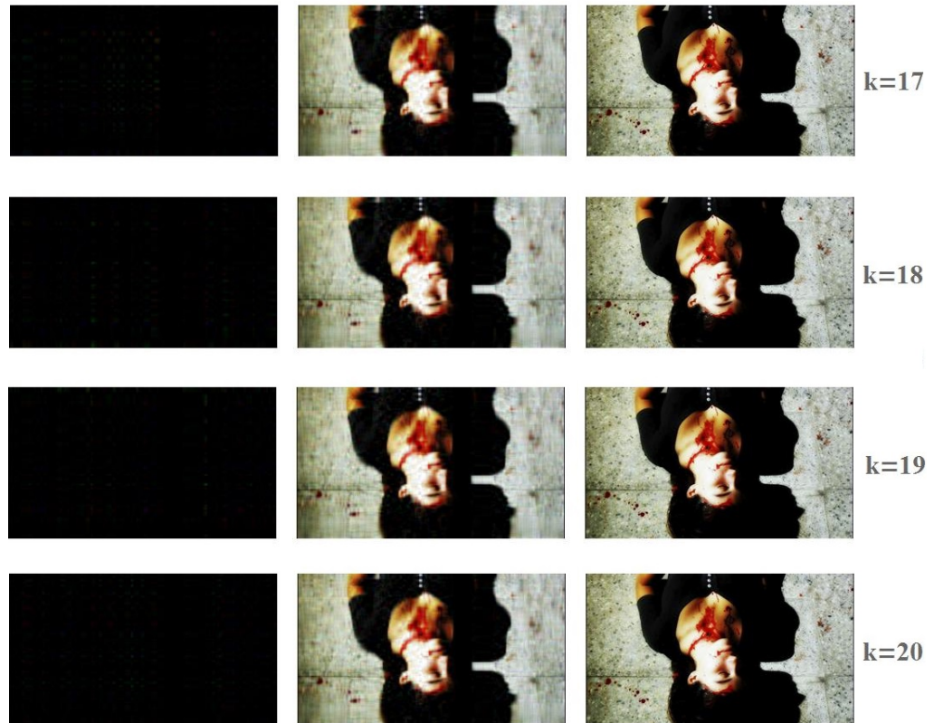
Figura A.4: La primera columna corresponde al producto tensorial \vec{u}_k \vec{v}_k^T , la segunda columna corresponde a \sum_{k=1}^{kMax} \lambda_k (\vec{u}_k \vec{v}_k^T) con kMax indicado a la derecha de cada renglón, la tercera columna es la imagen original
