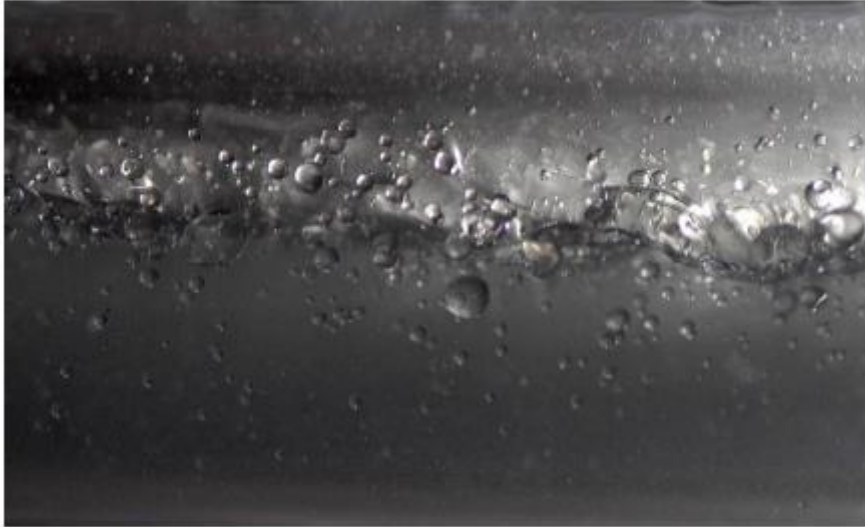
Figura 2.17. Dispersiones de agua en aceite y de aceite en agua (Kumara, 2008).
