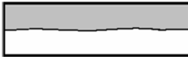
Figura 2.3. Flujo estratificado (Trallero, 1995).
