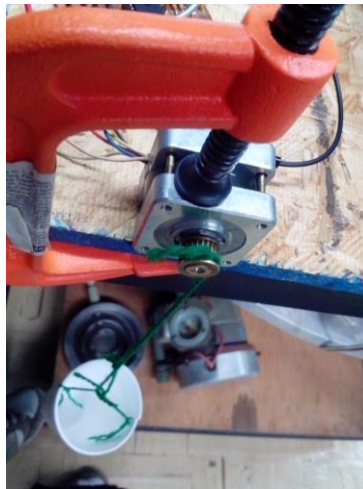
Figura 2.24: Montaje del experimento para las mediciones de velocidades con carga
