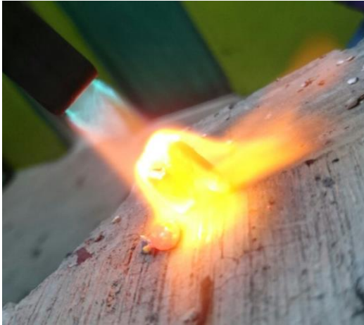
Imagen 5. Se le aplico fuego a los 4 minutos toma una coloración amarillenta y se observa una gota de color rojo.
