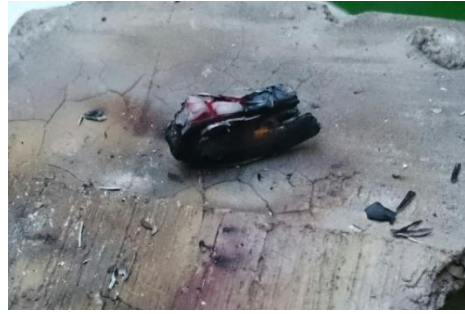
Imagen 22. Se observa como se ha quemado casi en su totalidad en su superficie se observan grietas.
