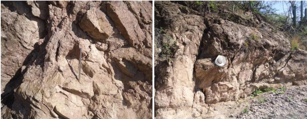
Figura 3.4.4.- Unidad de granito fracturado y alterado observada en campo.
