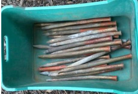
Figura 4.1.2.-Electrodos de aleación de cobre, acero y zinc.
