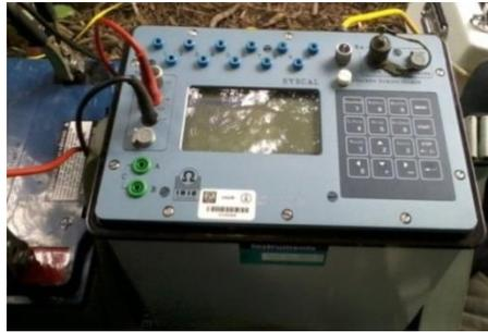
Figura 4.1.5.-Consola Syscal-Pro Switch
