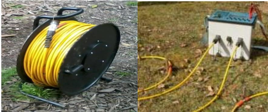
Figura 4.1.3.-Cables multicore utilizados en campo.
