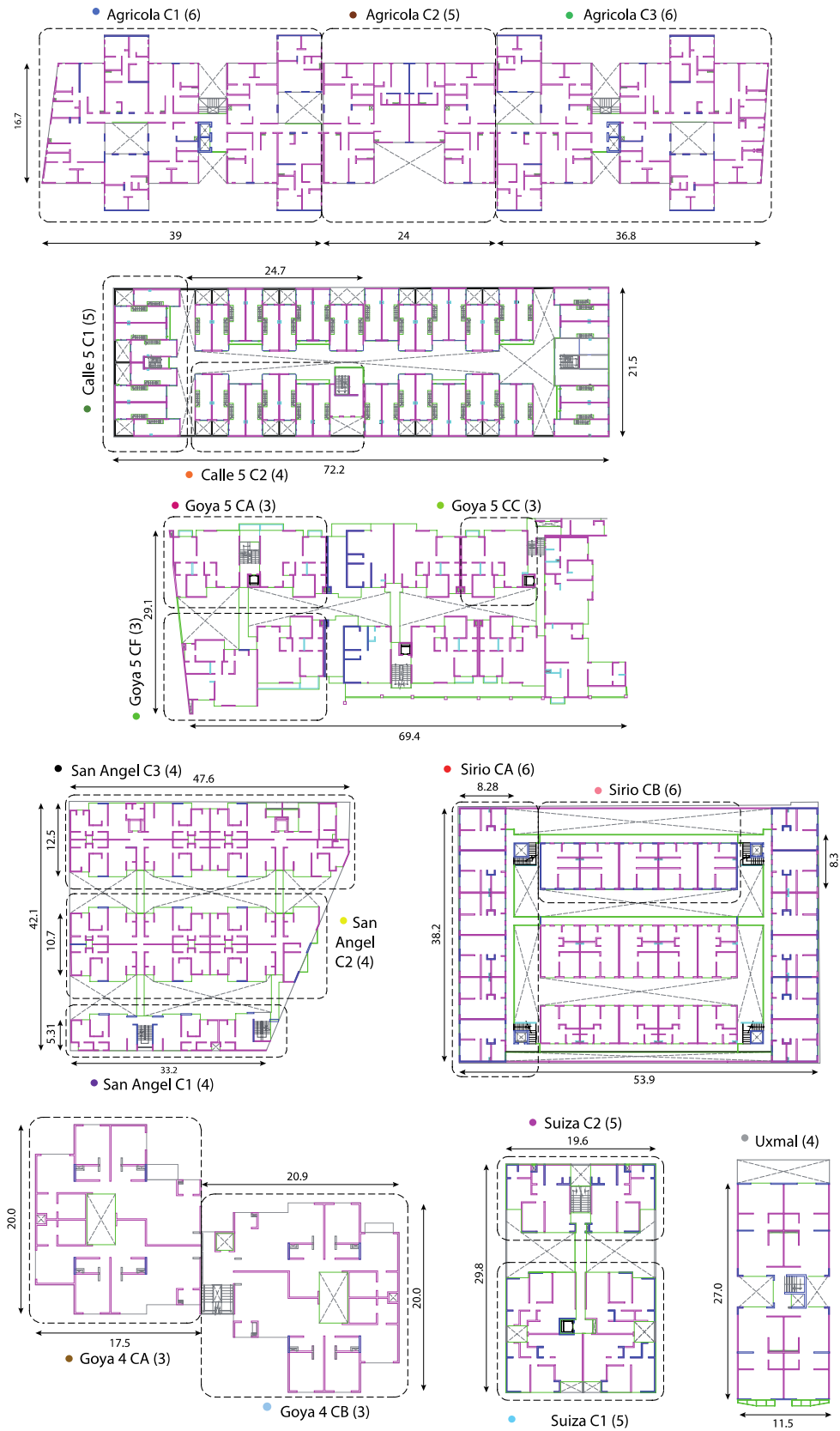
Figura 4.26. Plantas de estructuras analizadas; dimensiones en metros, número de niveles en paréntesis.
