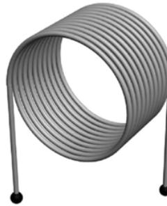
**Figura 1.12:** Sensor de densidad de flujo basado en un embobinado mas básico (6)
