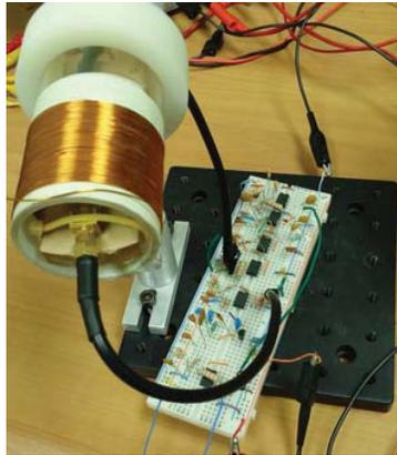
Figura 3.11: Prueba con campo magnético mediante le solenoide del prototipo de sensor.
