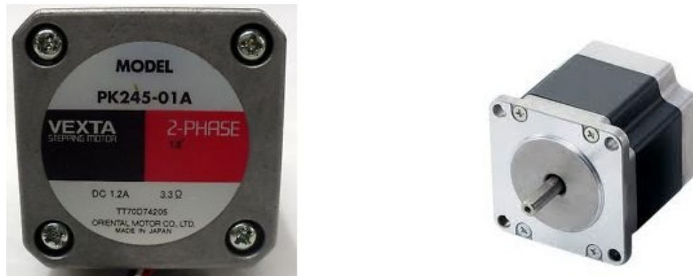
Figura 3.8 Fotografías del motor a pasos, marca Vexta, modelo PK245-01A, incorporado en el sistema de traslación Velmex.
