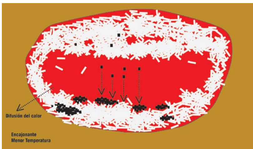
Fig. 5.12. Modelo esquemático de la formación de lentes de óxidos de Ti-Fe propuesto para el complejo Mariscal-Soconusco.
