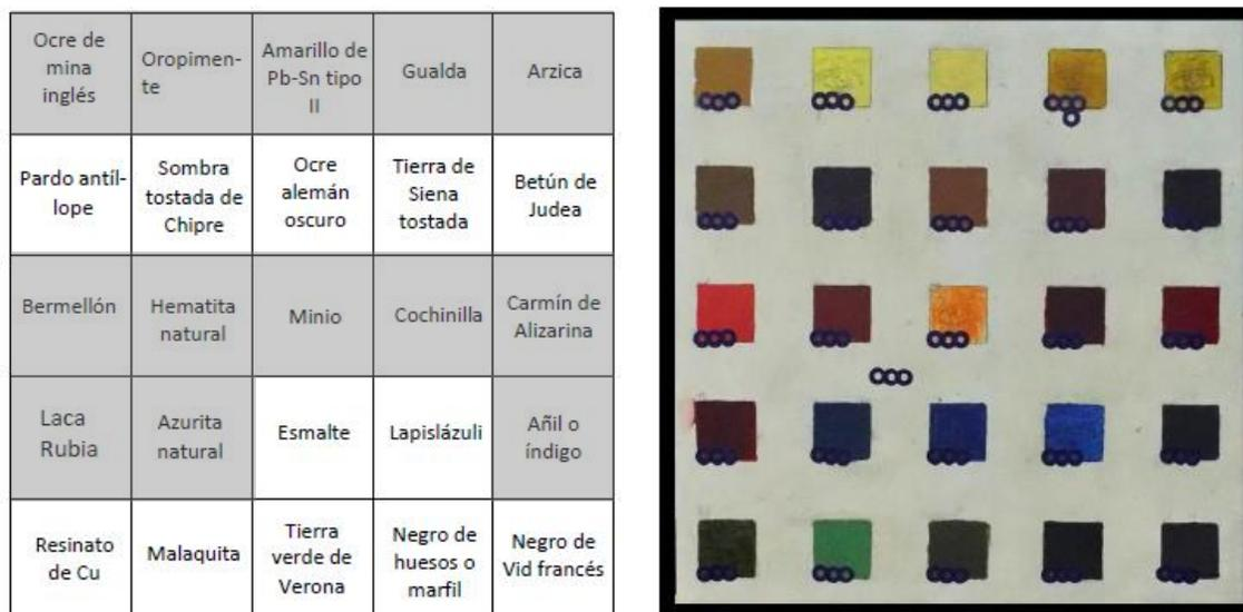
**Figura C1.** Distribución de los pigmentos en la tabla Y4. Los cuadros en gris representan los adquiridos con éxito mediante espectroscopia Raman de 1064 nm.
