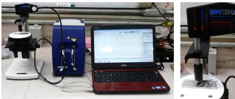
**Figura 3.3.** Espectrómetro portátil de la compañía BW-TEK durante la medición de una muestra de cochinilla. Fotografía: Angélica García
