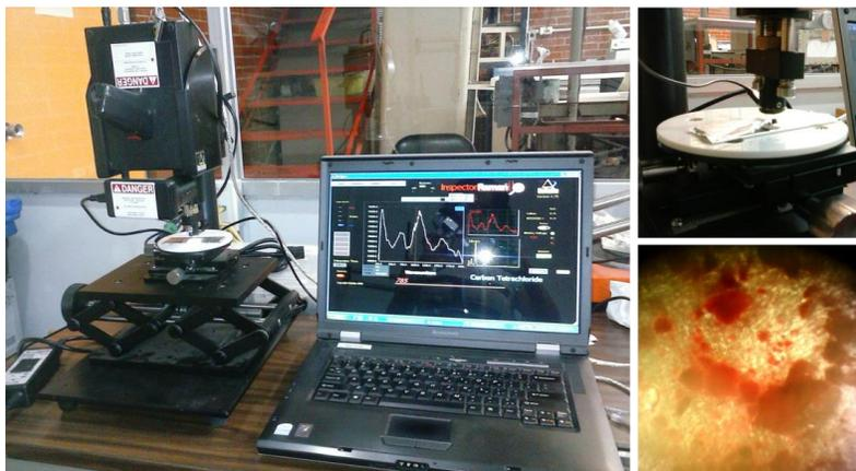
**Figura 3.2.** Equipo Raman portátil de la compañía Delta-Nu durante la medición de una muestra de cochinilla. La imagen inferior derecha fue obtenida mediante el microscopio del equipo durante un análisis con SERS. Fotografía: Angélica García.
