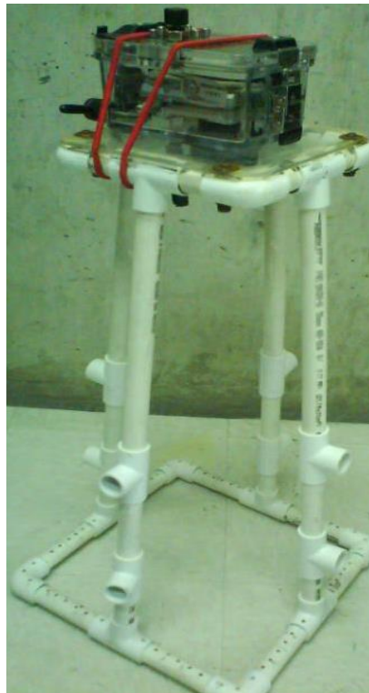
Figura 4. Estructura de PVC en la cual se monta la cámara para la toma de las fotografías.
