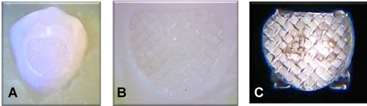
Figura 31: Especímen representativo de la prueba de esfuerzo de adhesión con adhesivo Experimental de 1 paso, posterior al desprendimiento visto al microscopio óptico A) Superficie dental 20X B) estructura dental 200X, C) Base del bracket 20X
