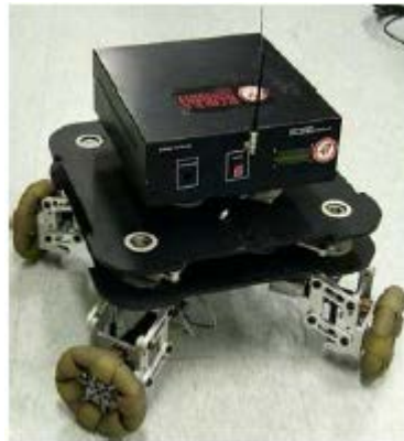
Figura 4. Foto del Robot Móvil Omnidireccional con ruedas direccionables. Tomada de Jae-Bok Song 2006.
