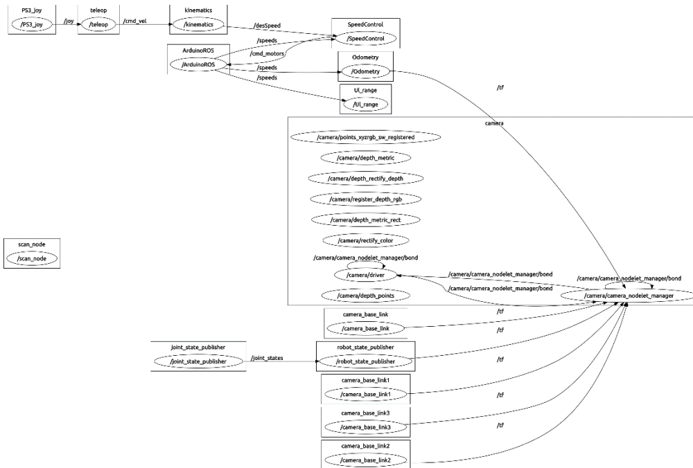
Figura 53. Esquema de nodos y tópicos principales del Robot Móvil Omnidireccional.
