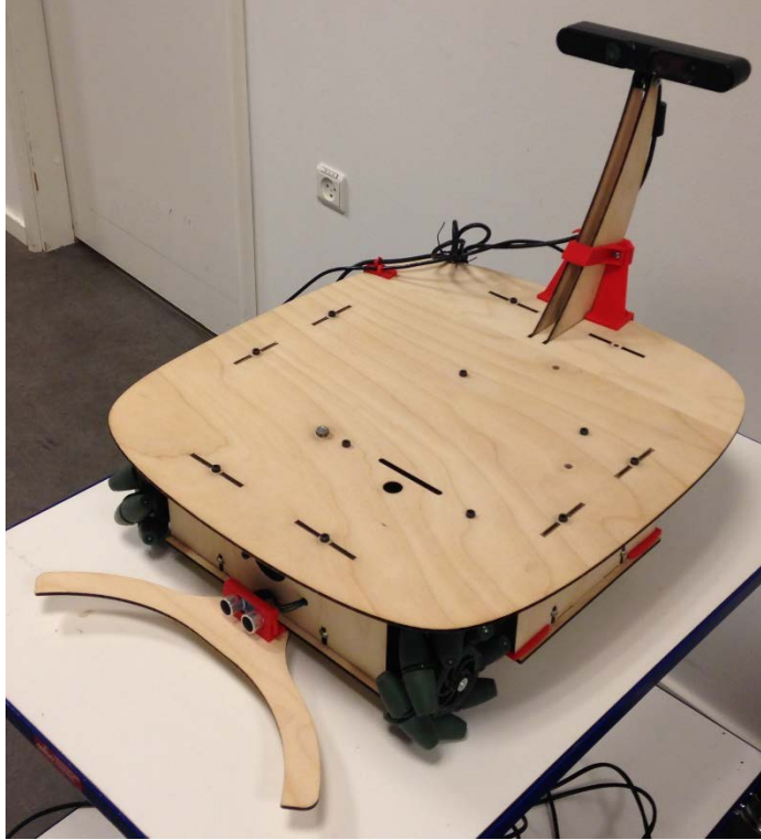
Figura 28. Foto del Robot Móvil Omnidireccional ensamblado.
